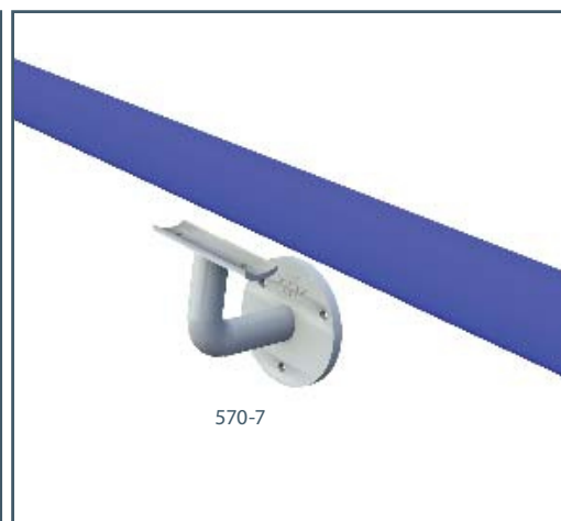
C) FIXARE PE PERETE : Fitingul 570-7 este fixat pe perete sau stalp de lemn utilizand suruburi sau prezoane de 6 mm. Fitingul 570-7 este atasat de teava cu suruburi autoforante nr.12 sau nituri pop.
